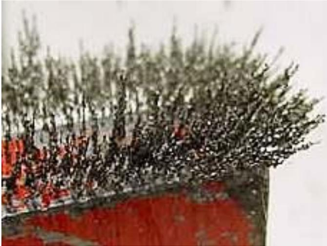
Das magnetische Feld um einen Magneten ist räumlich ausgedehnt.
