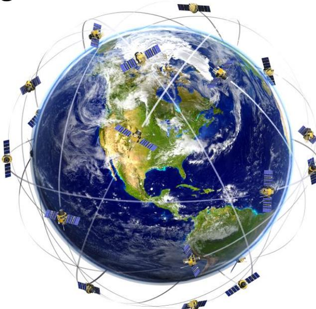
Aus der Laufzeit eines Signals verschiedener Satelliten mit synchronisierten Uhren kann eine genau Standortbestimmung berechnet werden.
