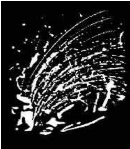
\beta^- -Teilchen eines Isotops im Magnetfeld
